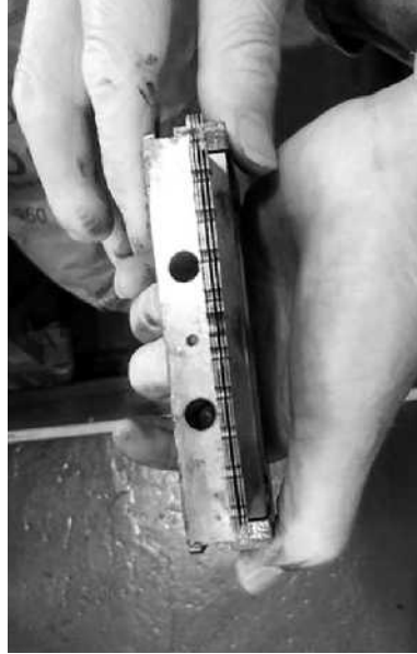
④カギ状極細フラスを成形する金型⑤その金型をセットした状態
